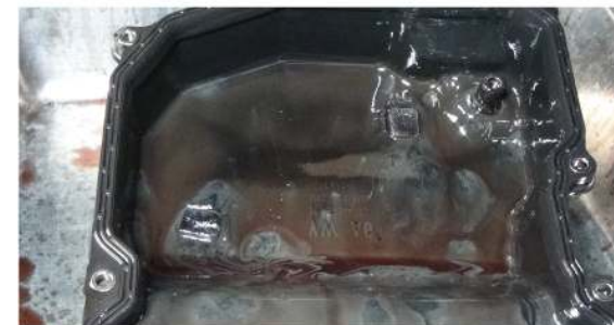
③オイルパンに溜まったスラッジ、鉄粉をきれいに洗浄して落とします。
