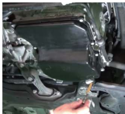
⑤オーバーフローチューブを取り付けます。
