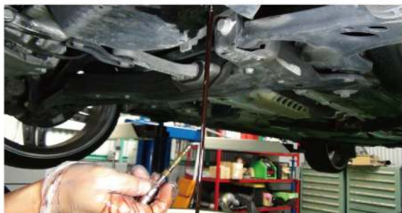
①ドレンプラグ・オーバーフローチューブを外してオイルを排出します。
