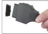
OBDIIの端子にテスターを接続。別の12Vバッテリーを接続。車両バッテリーの一端子を外します。
