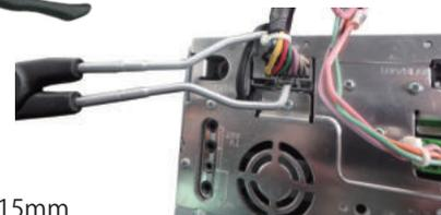
リレーの断線、作動不良等をLEDで簡単に良品判定!!
