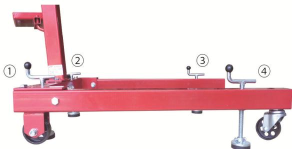
ストッパーを使用して固定する際は①～④のハンドルを均等に少しずつ絞め方向に回しキャスターが床から浮いたら締め込みをやめて下さい。
