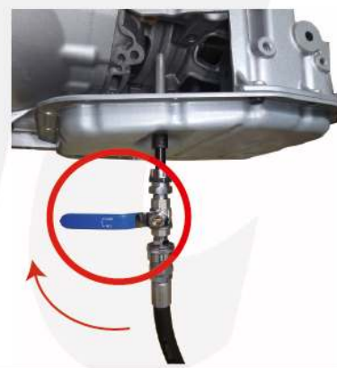
3. コックを閉じて暖機後、2.と同様のオーバーフローさせます。
