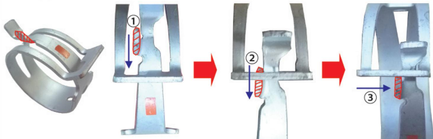
写真の赤い爪を①→②方向にくぐらせ、③横にずらし開いた状態でロックするタイプのホースバンドです。
