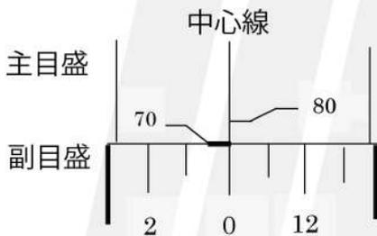
70 N・m の時は副目盛の 0 の位置と主目盛 70 の目盛りの線が重なるように合わせて下さい。72 N・m にする時は、副目盛を 2 に合わせて下さい。(他の値に設定する際も同様です。)
