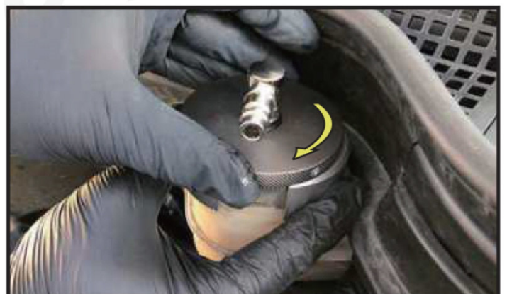
アームを閉じ、上部カバーを回転させてアダプターを固定します。
