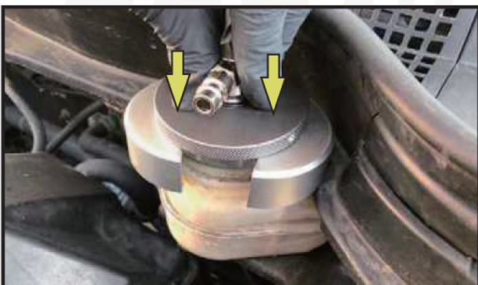
アダプターをマスターシリンダーリザーバーフィルターネックに押し込みます。
