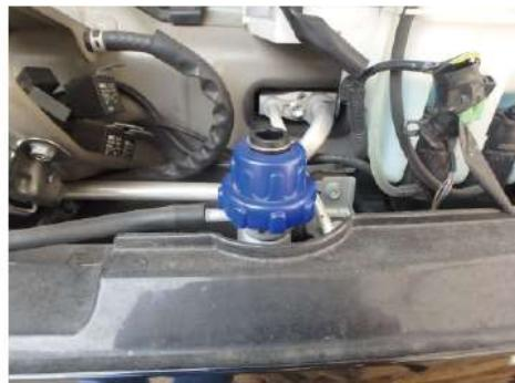
3. ファンネルのコックが閉まっているのを確認して、アダプターに接続して下さい。
