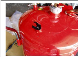
2、クリアタンクを本体のタンクに固定します (ネジ部にシーラ剤を塗布して接続ください)
