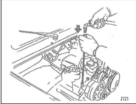
1. 使用する車輛のオイルレベルゲージに適したホースを選択して、吸入ホースに確実に接続してください
