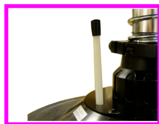
タンク内容量は、浮子式ゲージでわかります。
